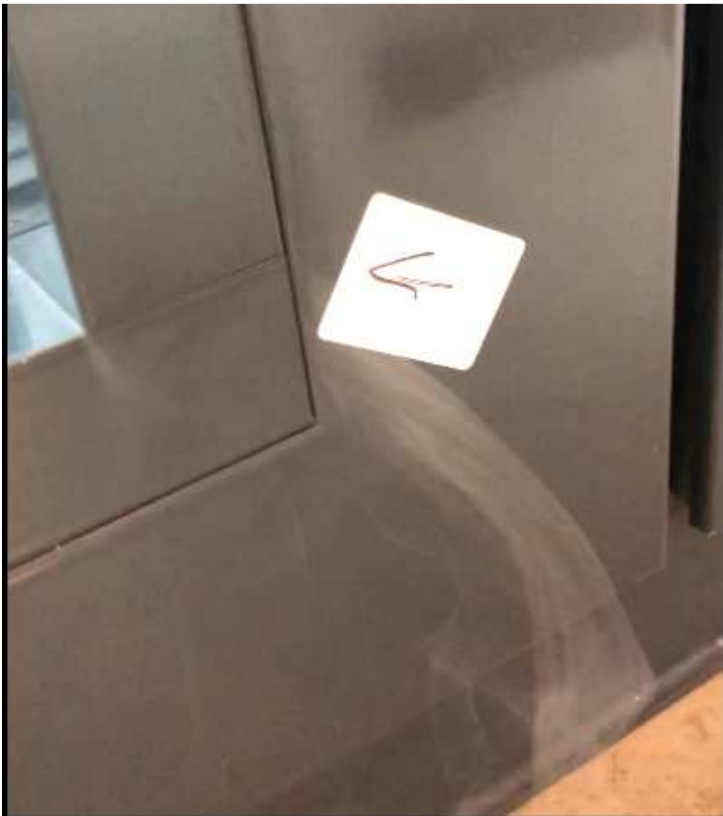
Rauch zieht durch Fugen und Schlitzze
