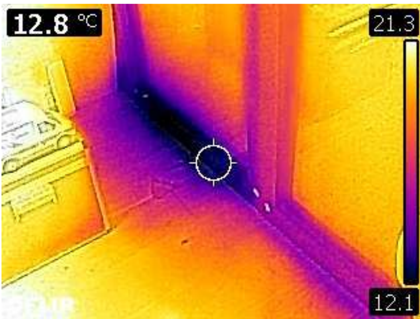
Innenaufnahme: Hoher Temperaturunterschied im unteren Bereich des Fensters
