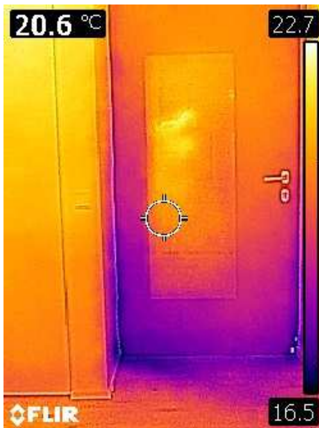
Innenaufnahme: Hoher Temperaturunterschied im unteren Bereich der Tür
