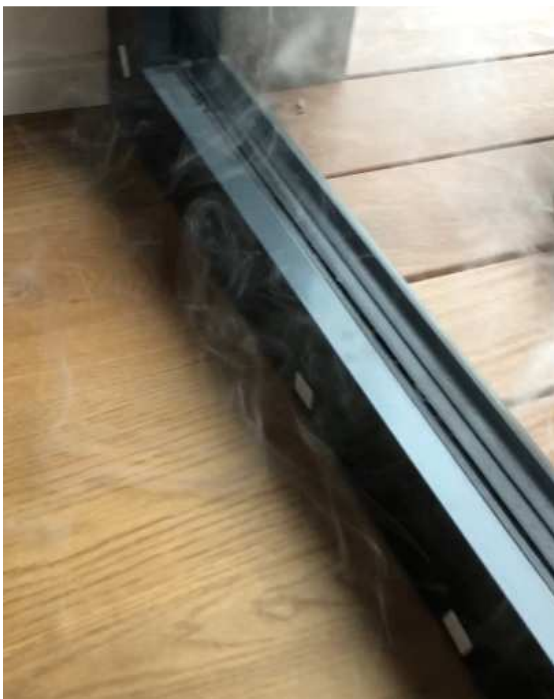
Rauch unter das Parkett / Innenaufnahme: Hoher Temperaturunterschied im unteren Bereich des Fensters
