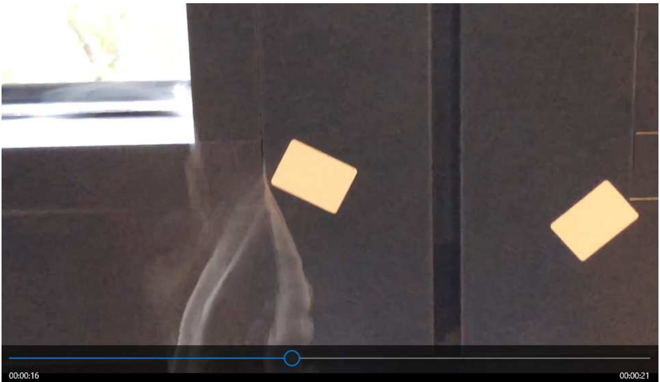
Rauch zieht durch Fugen und Schlitz
