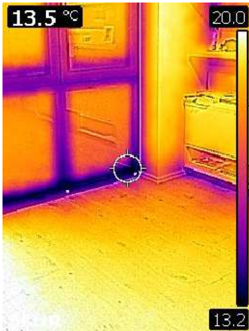
Innenaufnahme: Hoher Temperaturunterschied im unteren Bereich des Fensters
