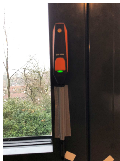
Ein Test mit einem Anemometer von Testo ergab einen Volumenstrom von 3240 m 3 /h an einem einzelnen Schlitz.
