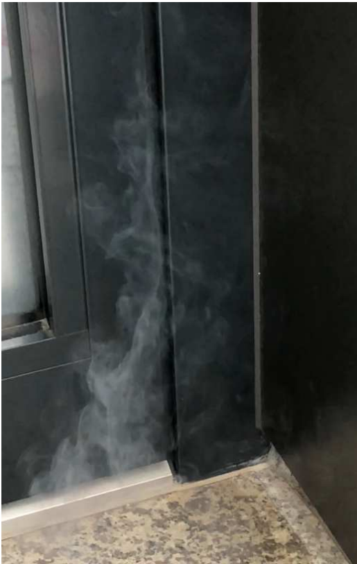
Starke Rauchentwicklung im unteren Bereich der Tür sowie Türblatt
