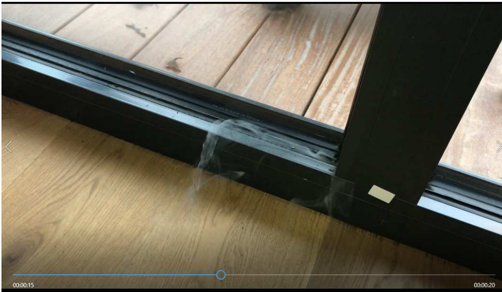
Rauch zieht durch Fugen und Schlitz
