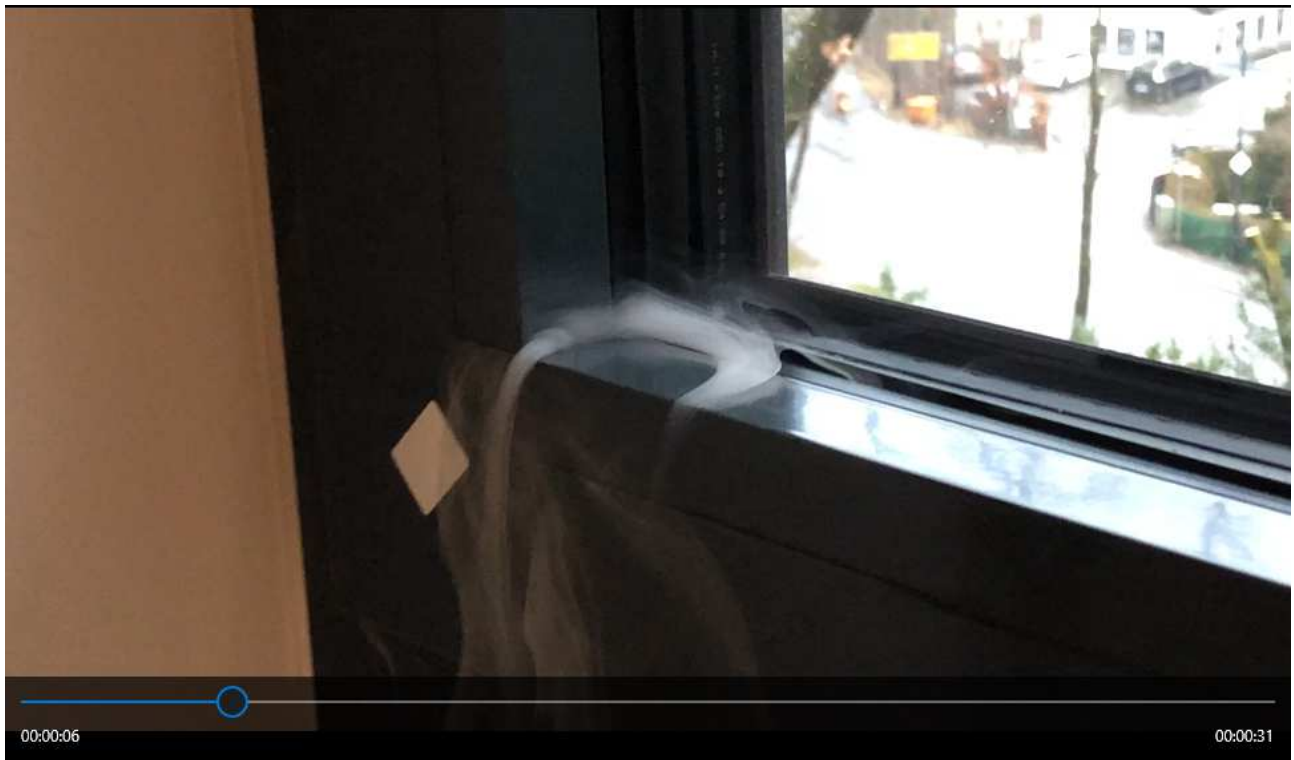
Rauch zieht durch Fugen und Schlitzze
