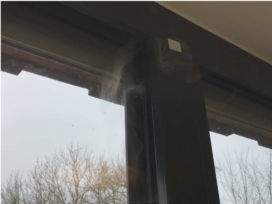
Rauch zieht durch Fugen und Schlitz
