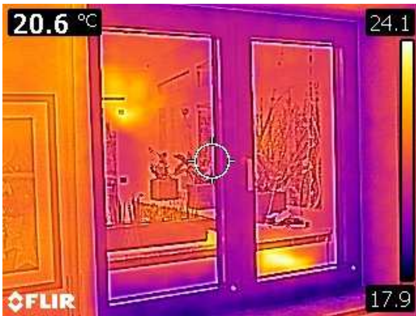
Innenaufnahme: Hoher Temperaturunterschied im unteren Bereich des Fensters
