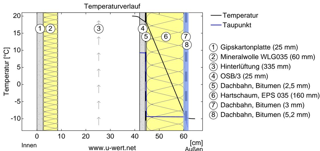
Verlauf von Temperatur und Taupunkt innerhalb des Bauteils. Der Taupunkt kennzeichnet die Temperatur, bei der Wasserdampf kondensieren und Tauwasser entstehen würde. Solange die Temperatur der Konstruktion an jeder Stelle über der Taupunkttemperatur liegt, entsteht kein Tauwasser. Falls sich die beiden Kurven berühren, fällt an den Berührungspunkten Tauwasser aus.
