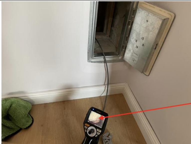
Endoskopierung der Revisionsöffnung des Schornsteins
