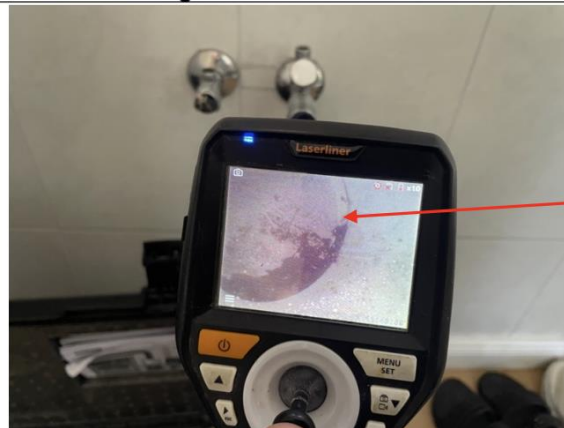
Befahrung des Abwasserrohres ohne sichtbare Schäden
