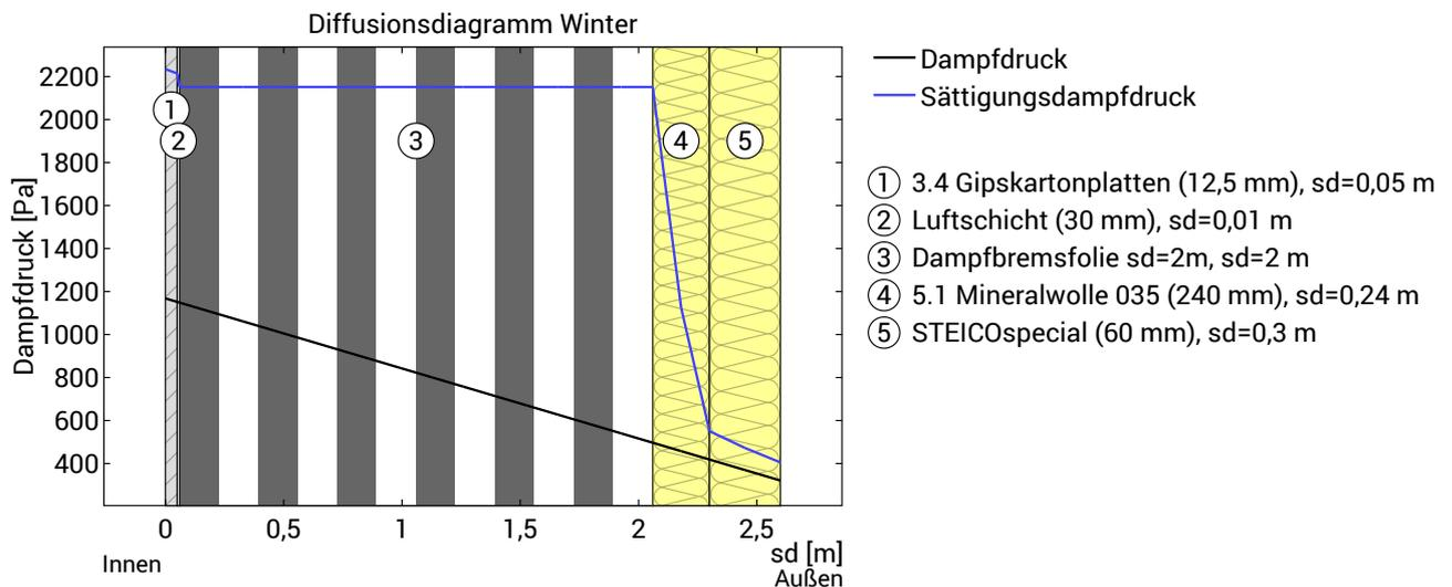
Unter den angenommenen Bedingungen ist der untersuchte Querschnitt frei von Tauwasserbildung im Bauteilinneren.
