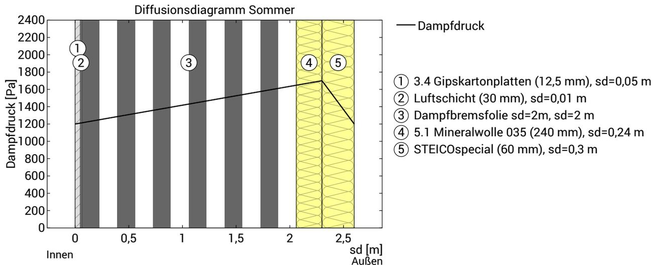
Tauwasserfreies Bauteil: Es wird die maximal mögliche Verdunstungsmasse für die Trocknungsreserve berechnet.
