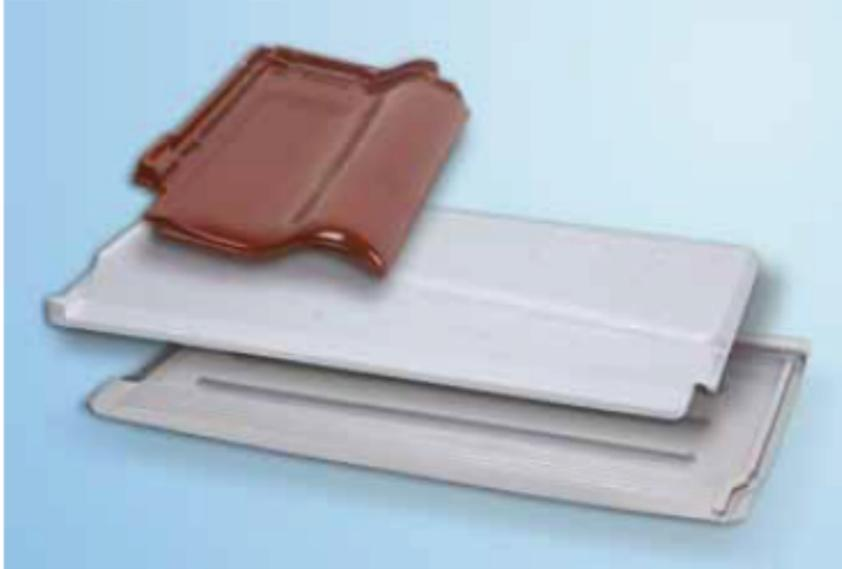
Thermodach ‚Protect‘ ist ein wasserführendes Dachsanierungssystem für Wärme und Feuchtigkeitsschutz im Steildach. Die Dämmstärken betragen 30 oder 40 mm. Die Verlegung der Thermodach ‚Protect‘ Elemente erfolgt zwischen den Dachlatten.
